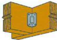
Refuerzo de ángulos de 90°
